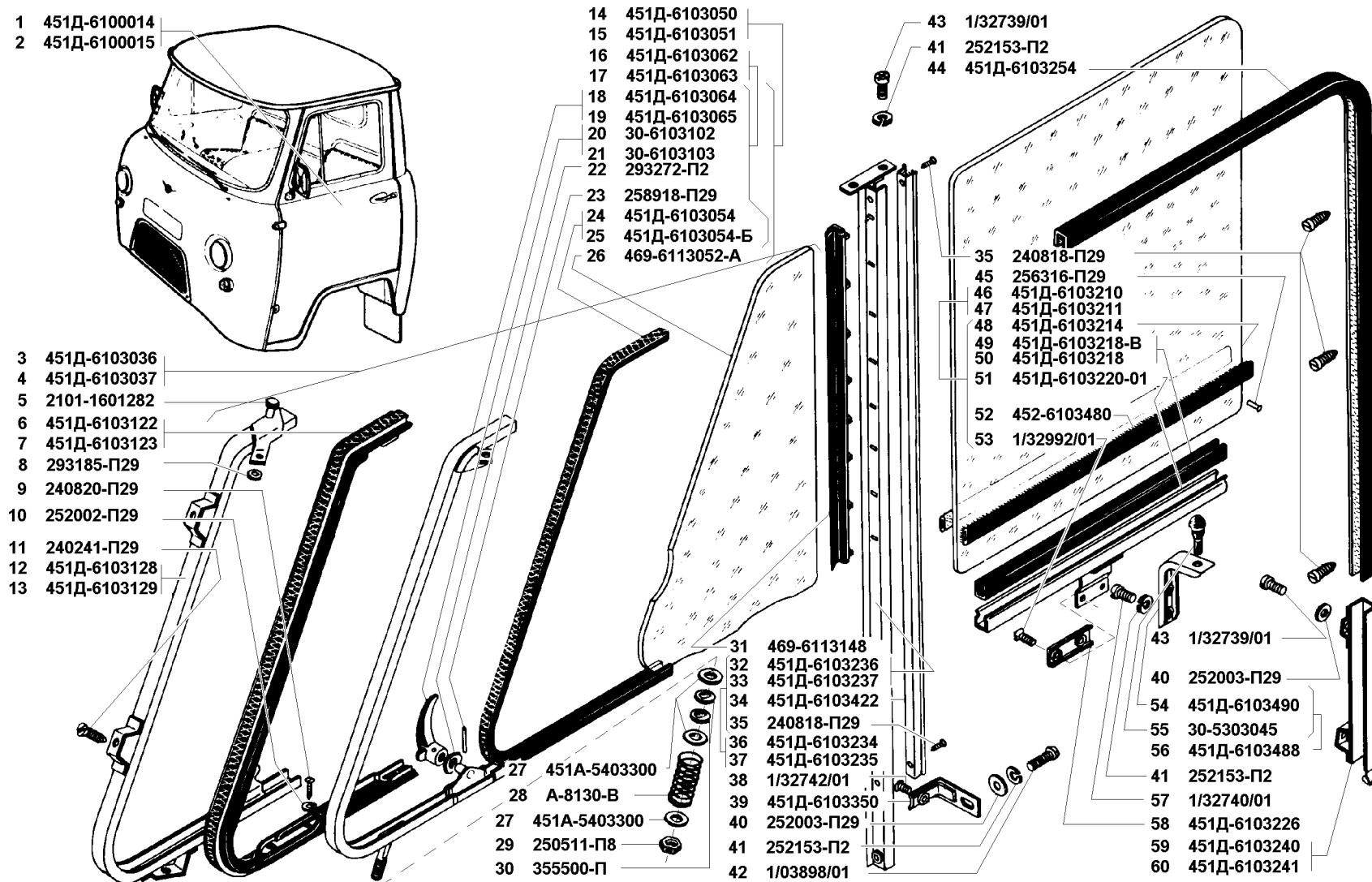
Рис. 133. Дверь передняя в сборе (6100), окно передней двери (6103)
