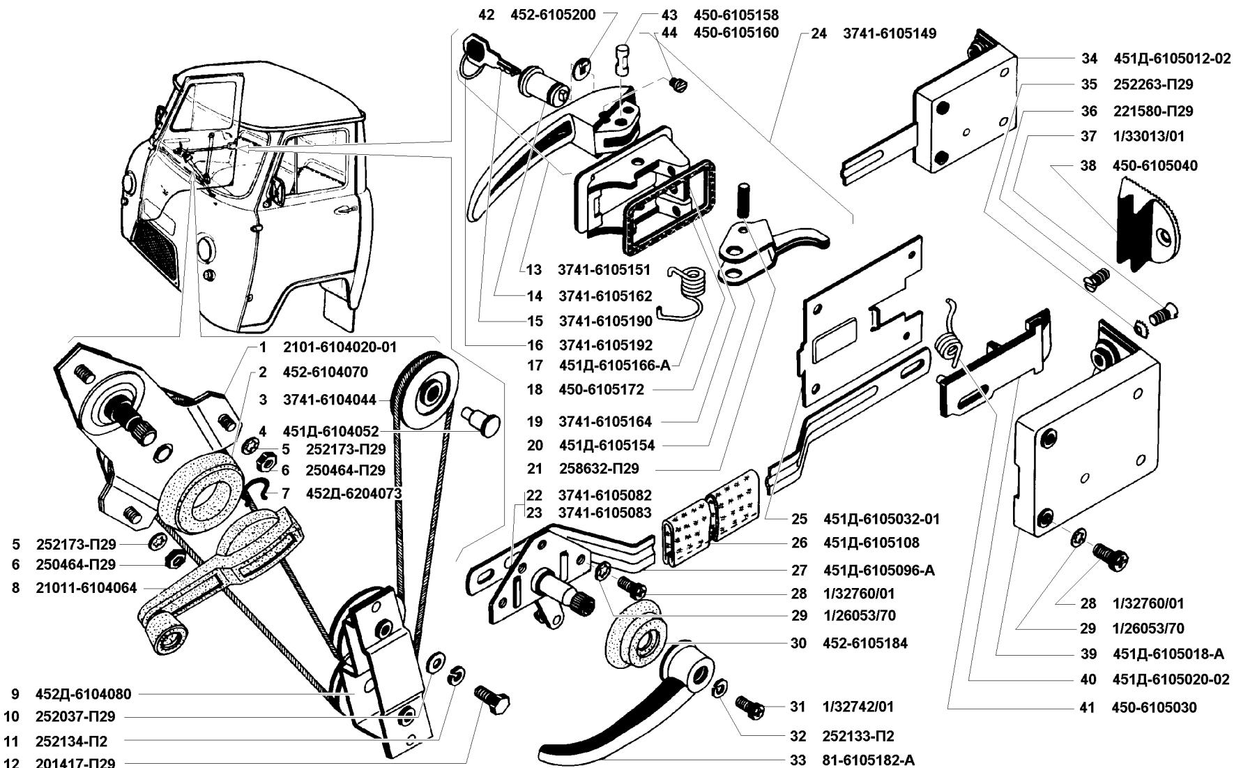
Рис. 134. Механизм перемещения стекла передней двери (6104), замок и ручки передней двери (6105)
